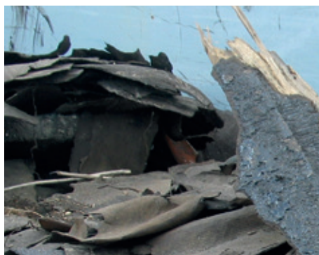
Ældre tagpap fra nedrivning. Ældre tagpap kan indeholde tjærestoffer. Tagpap deponeres eller genanvendes.
